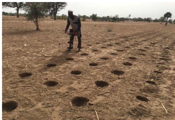
Figure 1. Creusage des poquets avec la machine zaï (I. B. Diouf).
