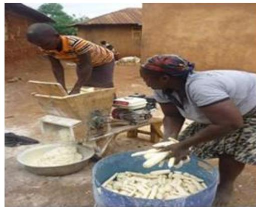
Figure 3. Râpage mécanique des tubercules de manioc.
