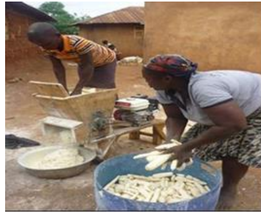
Figure 3. Râpage mécanique des tubercules de manioc.
