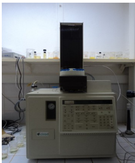
Figure 3 : Photographie du Chromatographe en Phase Gazeuse (VARIAN CP – 3800, France)
